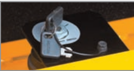
Interruptor principal de la batería
